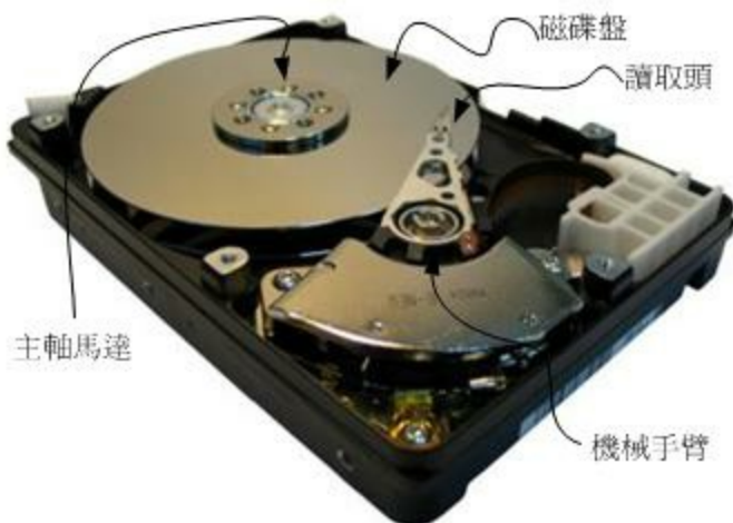
图0.2.4、硬盘物理构造（图片取自维基百科）
